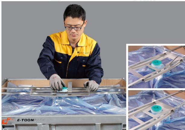
移除铅封，松开箱体两侧的竖向插销，打开顶盖。
