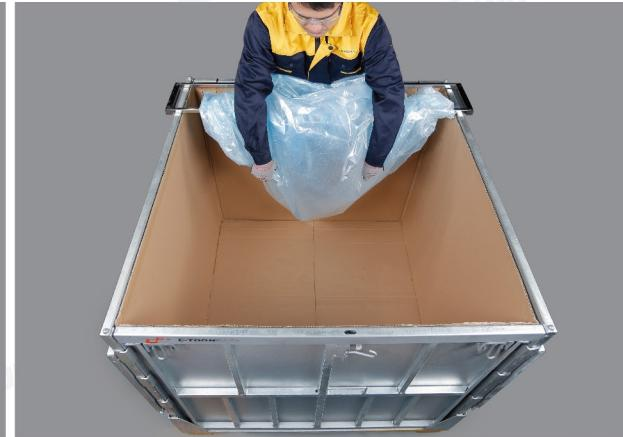
当液位贴近箱底时，向上提拉液袋，并将其卷起缠绕在固定桥上，然后用A型夹固定。
