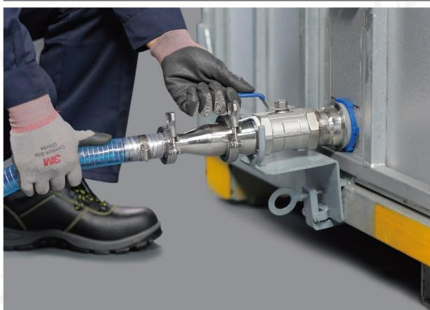
安装下卸料支架，并与卸料阀门固定。
