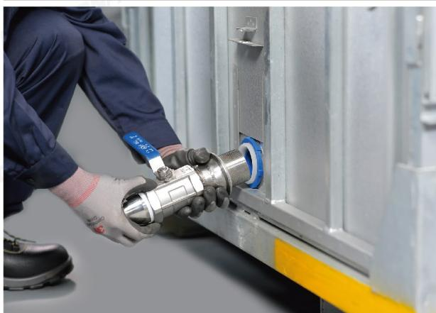
打开易通箱底部的液袋出料口封盖，取出里面的锯齿圆环，然后将有锯齿一端朝内放入喷嘴（注意不要刺破液袋）。
