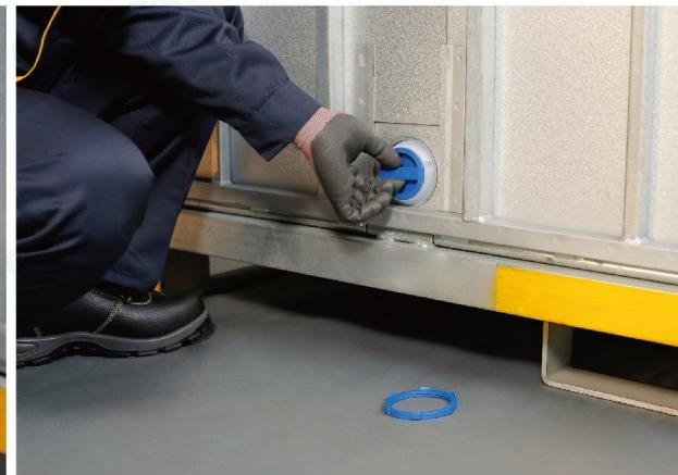
当卸料结束后，松开卡箍，依次取下软管和卸料阀门。
