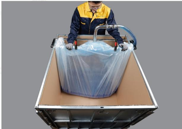
将抽料管插入液袋进料口喷嘴，然后连接管线，开始抽料。
